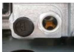
На насосе откройте пробку слева и слейте отработанное масло
