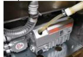
Откройте пробку сверху и залейте в отверстие масло.
