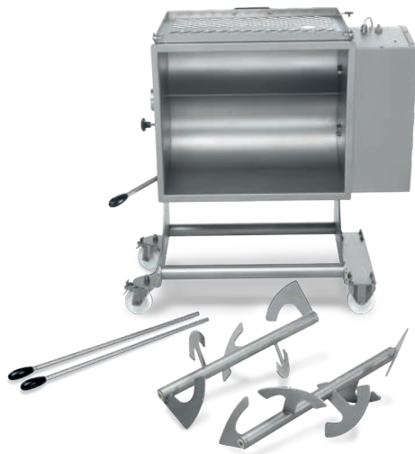
Pala facilmente rimovibile Removable mixing arms
